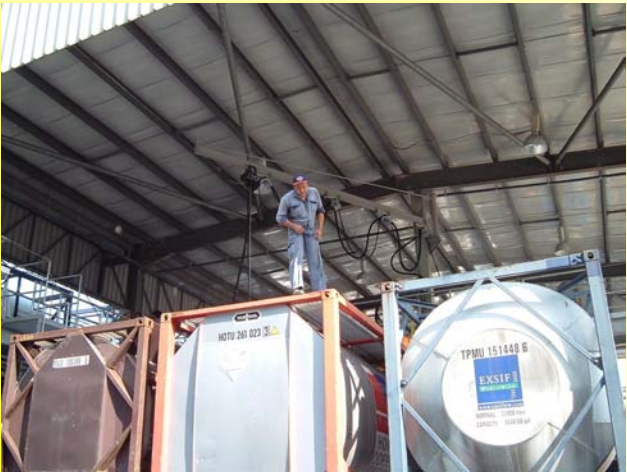
Anordnung Reinigungskopf Seitenlader
