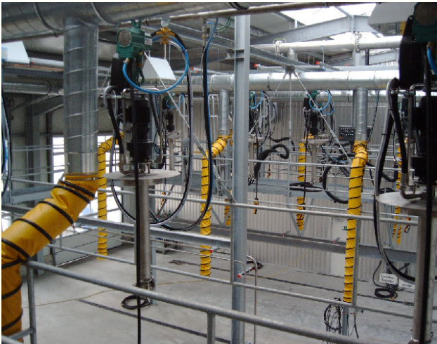
Reinigungslinie Ex mit Drucklufthebezeugen, Trocknung
