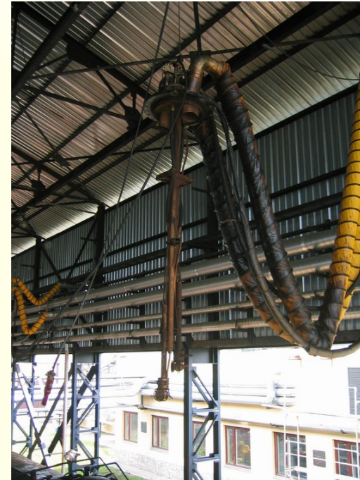
Anordnung Innenreiniger HKF 200 K2 Grundstellung
