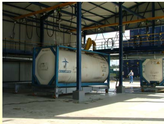
Reinigungslinie Transport auf Chassis
